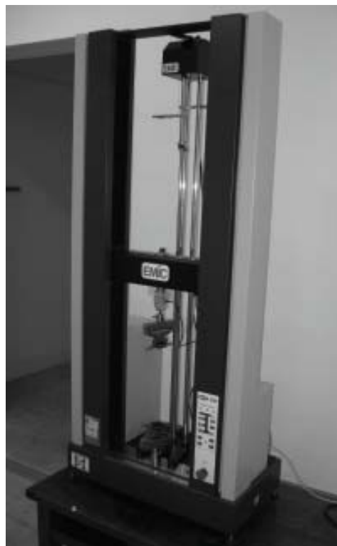
Máquina universal de ensayos, del Laboratorio de Investigaciones de Metalurgia Física
